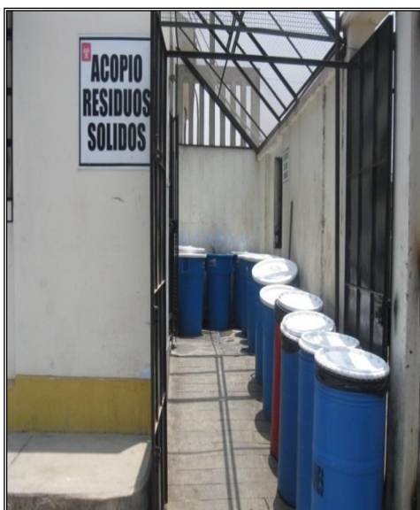
Se Observa el almacenamiento Central el cual cuenta con dos ambientes uno para residuos comunes (recipientes de color azul), carece de techo y el otro ambiente para residuos biocontaminados con techo (recipientes de color rojo).
