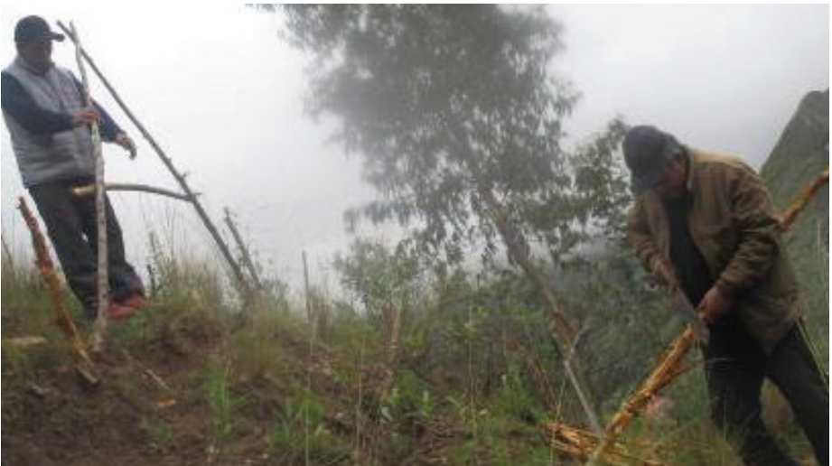
Trazado de las curvas de nivel utilizando el nivel A
